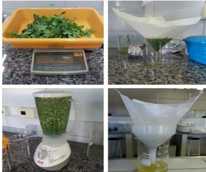
Figura 1 - Fases de produção de extrato aquoso por trituração. 1. Pesagem do material vegetal. 2. Trituração em liquidificador doméstico. 3. Extrato aquoso.
