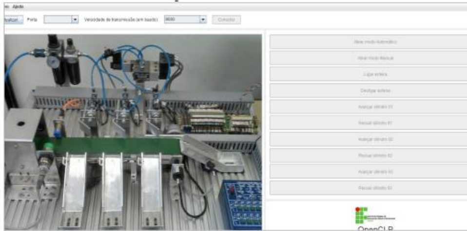
Figura 04 – Software Supervisor – Controle das saídas via PC.
