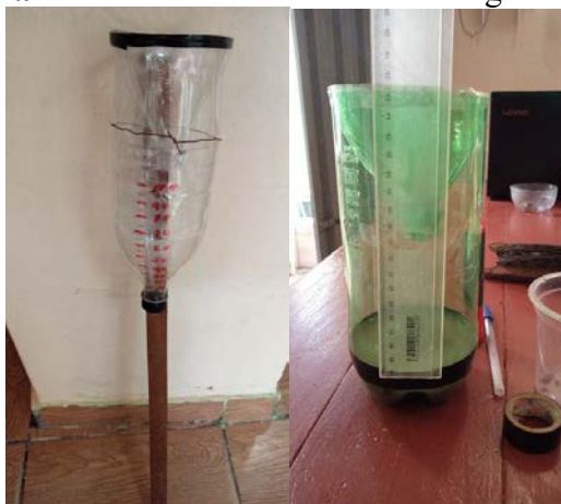
Figura 1 – Pluviômetros Artesanais de garrafa pet.
