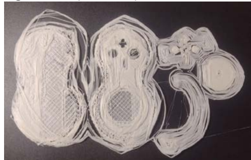
Figura 2. Impressão que falhou com filamento ABS.
