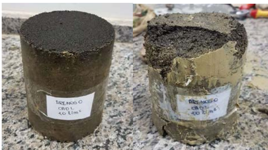
Figura 6 - Aparência dos corpos de prova imprimado com CADL antes e depois do ensaio de permeabilidade
