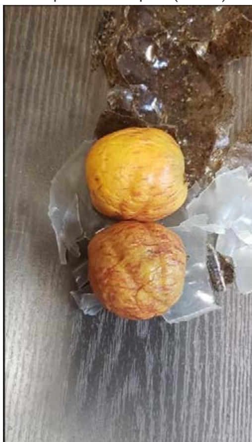
Figura 5 – Maçã com bioplástico com casca de cebola (esquerda) e maçã com bioplástico simples (direita)
