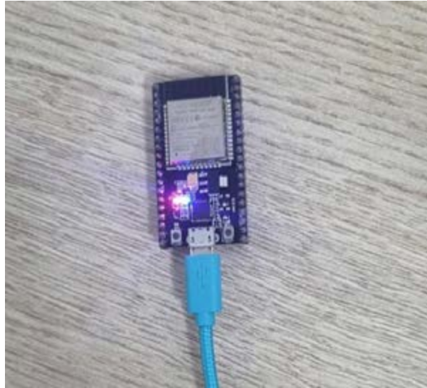
Figura 3 - Luz de led da placa ESP32s ligada
