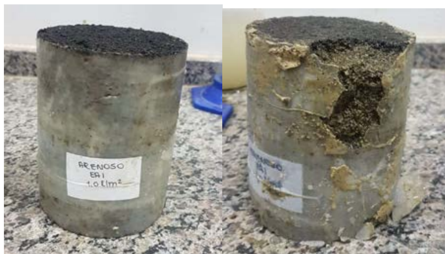
Figura 7 - Aparência dos corpos de prova imprimado com EAI antes e depois do ensaio de permeabilidade
