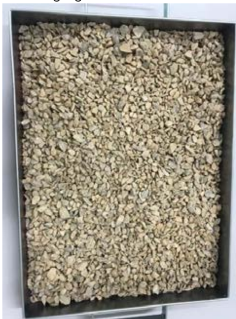
Figura 2 – Fração graúda do agregado alternativo usado na produção dos pavers
