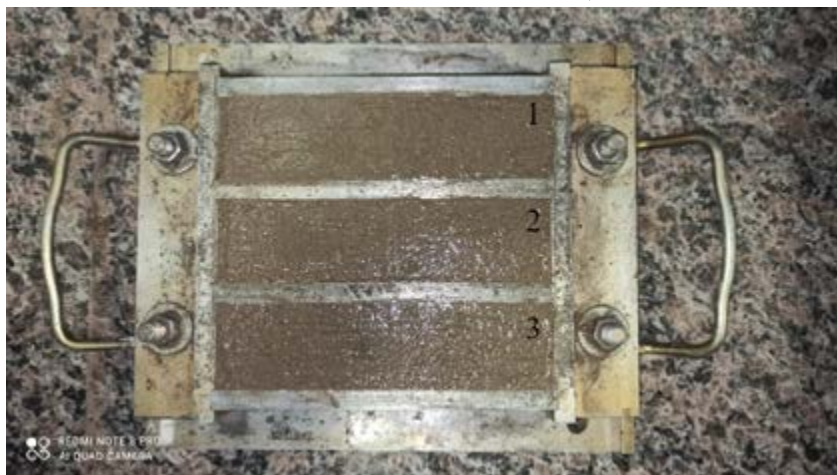
Figura 6 – Modelagem dos corpos de provas (Juazeiro do Norte - CE)
