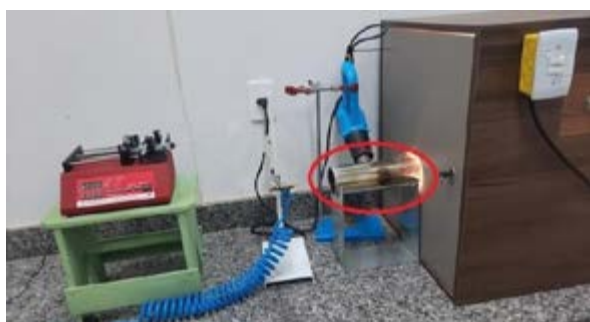
Figura 1 – (a) Equipamento adaptado com fonte de calor para a técnica Solution Blow Spinning - SBS e (b) Caixa coletora aquecida
