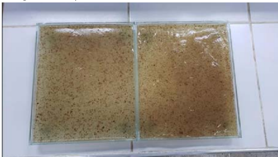
Figura 3 – Bioplástico funcionalizado com casca de cebola
