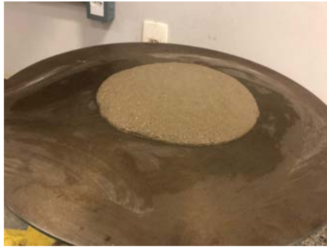
Figura 5 – Argamassa com 15% de cal ao final do ensaio de índice de consistência
