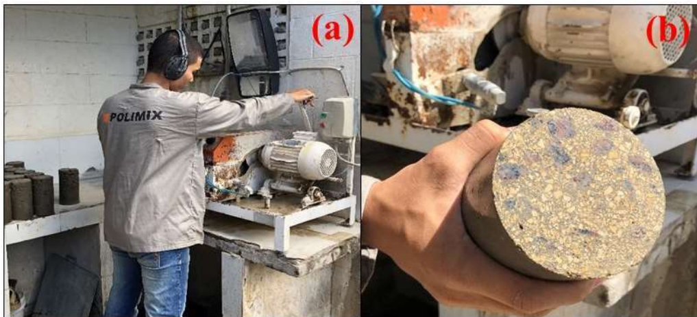
Figura 25 - Processo de retificação do corpo de prova: retificação do corpo de prova (a); aspecto do corpo de prova retificado (b)
