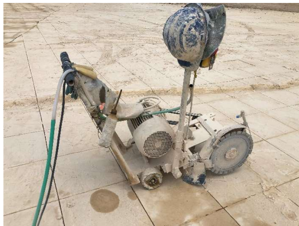
Figura 2 - Equipamento de corte de placas do calcário laminado
