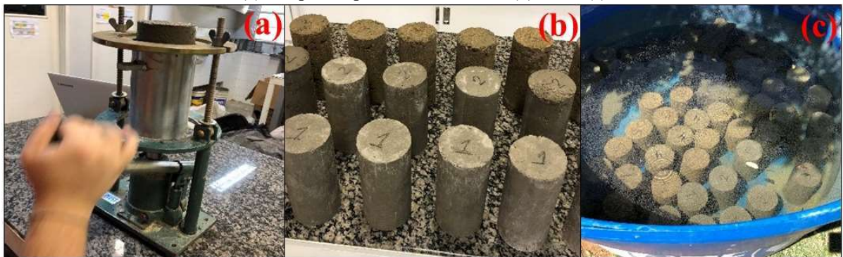
Figura 24 - Procedimento de extração, identificação e cura dos corpos de prova: extração do corpo de prova (a); corpos de prova identificados (b); cura (c)
