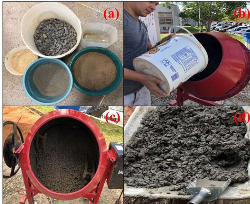
Figura 21 - Etapas da execução da mistura: proporção dos materiais pesados (cimento, areia, brita, água e RCL) (a); lançamento dos materiais na betoneira (b); mistura dos materiais (c); aspecto do concreto seco(d)
