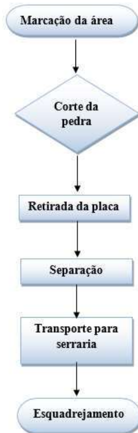
Figura 3 - Fluxograma do processo de extração
