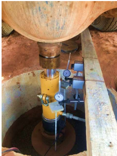
Figura 38 - Sistema de transmissão de carga
