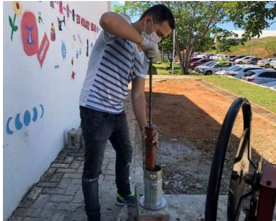
Figura 23 - Moldagem do corpo de prova com adensamento compactado
