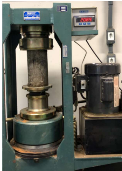
Figura 26 - Rompimento do corpo de prova do concreto
