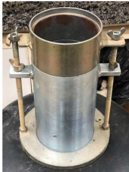
Figura 22 - Aparelho para moldagem: molde metálico, cilindro complementar e base metálica
