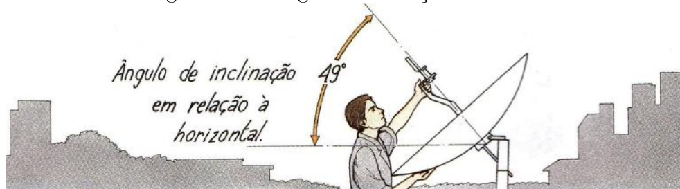
Figura 5.43: Ângulo de elevação da antena
