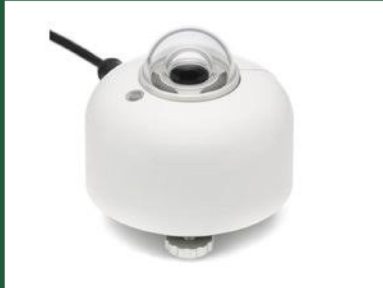
**PIRANÔMETRO: é um instrumento para medição de radiação solar com qualidade e precisão.**
